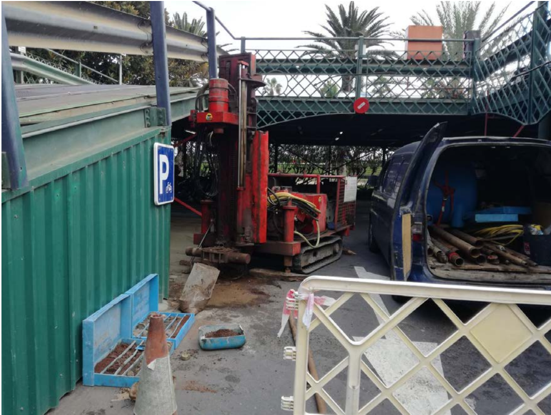
Foto 1: Perforadora Canarias instalada en el sondeo 1
